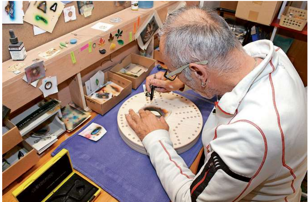
Nach dem Bohren der Löcher für das Spielfeld werden die Sujets per Airbrush-Verfahren aufgesprüht.
